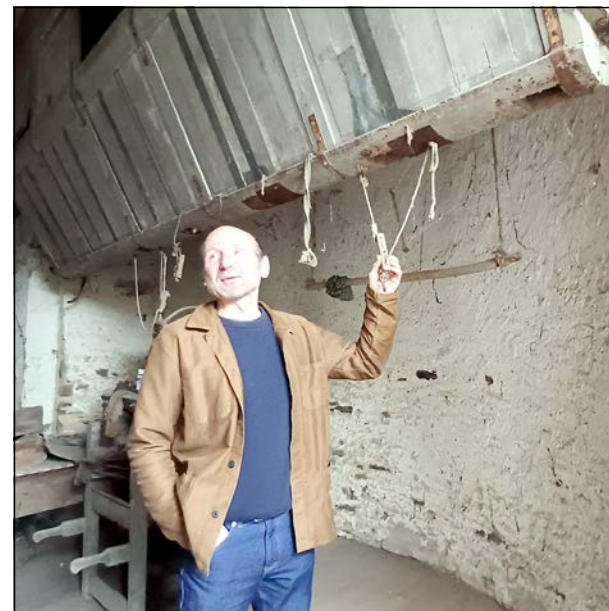
Au moulin du Thu, le temps s'est arrêté un jour de 1964. Ici la bluterie, un tamis qui sépare la farine du son. Thérèse FLEURY (clp)
